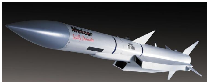
איור 2 - טיל ה - Meteor. מנוע באמצעות מג"ח דו מימדי
